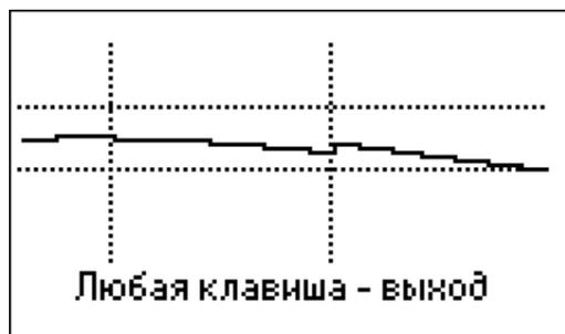
Кривая напряжения не должна выходить за обозначенные горизонтальными пунктирными линиями пределы (вертикальные пунктирные линии являются границами поддиапазонов анализатора).
