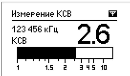
Можно установить частоту для измерения КСВ (кнопка **2**) или уменьшить/увеличить ее (кнопки «влево» и «вправо»). Нажатие кнопки **ok** начинает или останавливает измерение. Мигающая пиктограмма с изображением антенны (в правом верхнем углу экрана) показывает, что режим измерения включен. Нажатие кнопки **1** выводит на экран список других функций этого режима.
