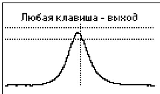
Вершина кривой должна находиться на середине экрана в области, очерченной горизонтальными пунктирными линиями. Допускается незначительный сдвиг характеристики по частоте.
